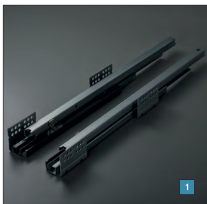
Funkcija potpunog izvlačenja i tiho zatvaranje (soft-close) karakteriziraju ovu vodilicu za ladice.
